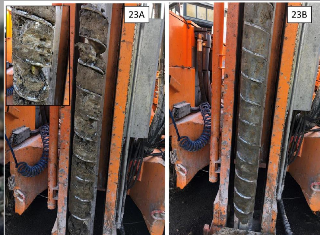
Figur 2-2: Bilder fra prøvepunkt M23. 0-1 m sjiktet består av fyllmasser blandet med tørrskorpeleire (M23A). Underliggende lag består utelukkende av tørrskorpeleire med grå farge (M23B).
